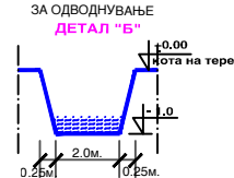
ПОПРЕЧЕН ПРОФИЛ НА ОТВОРЕН КАНАЛ ЗА ОДВОДНУВАЊЕ ДЕТАЛ "Б"
